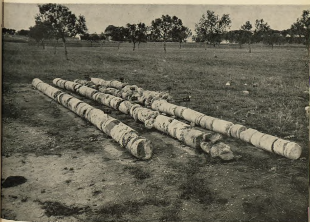
Fot. 4 - Campioni di « carote » estratte dalla perforazione.
