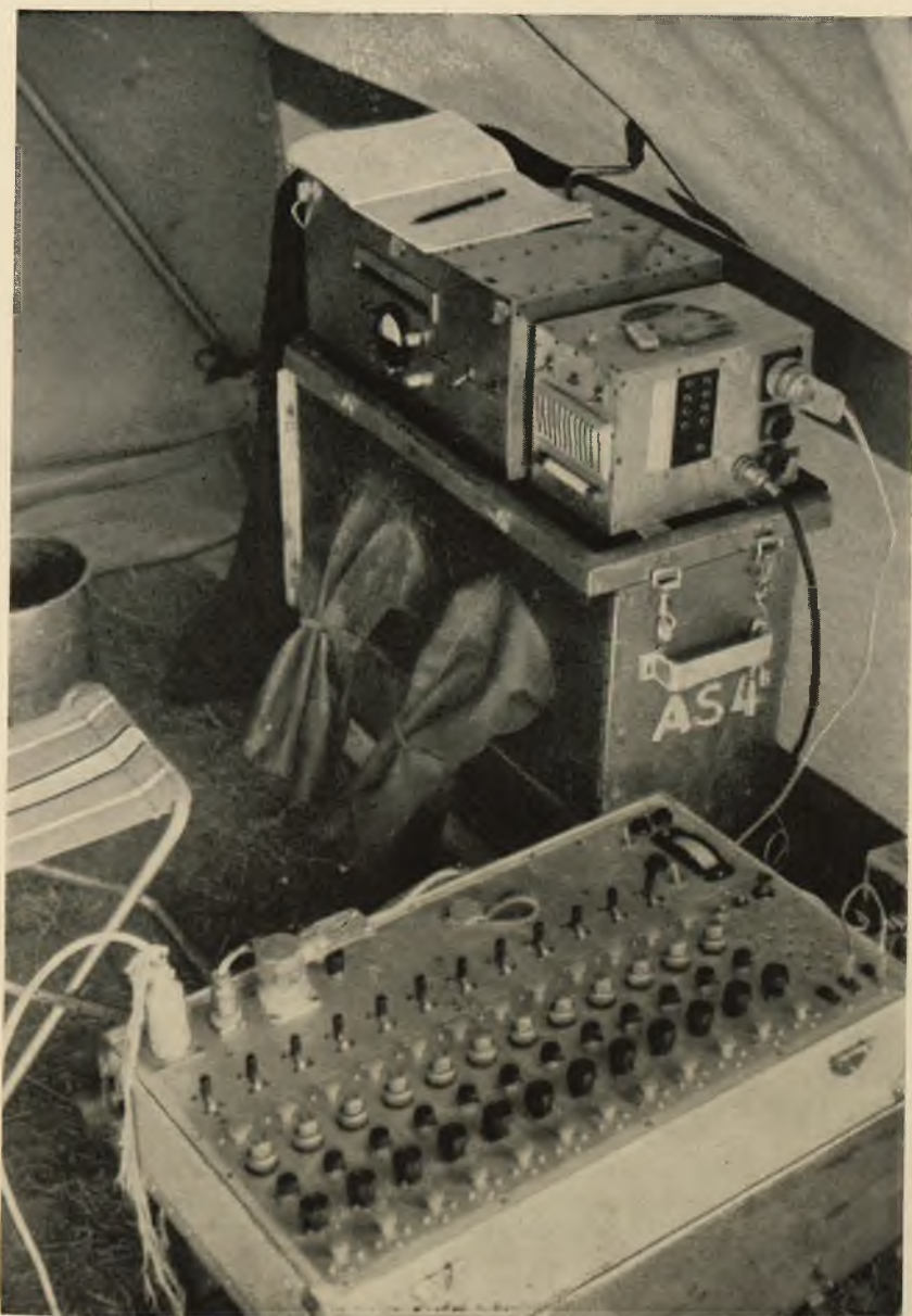
Fot. 3 - Attrezzature per sismica a rifrazione.
