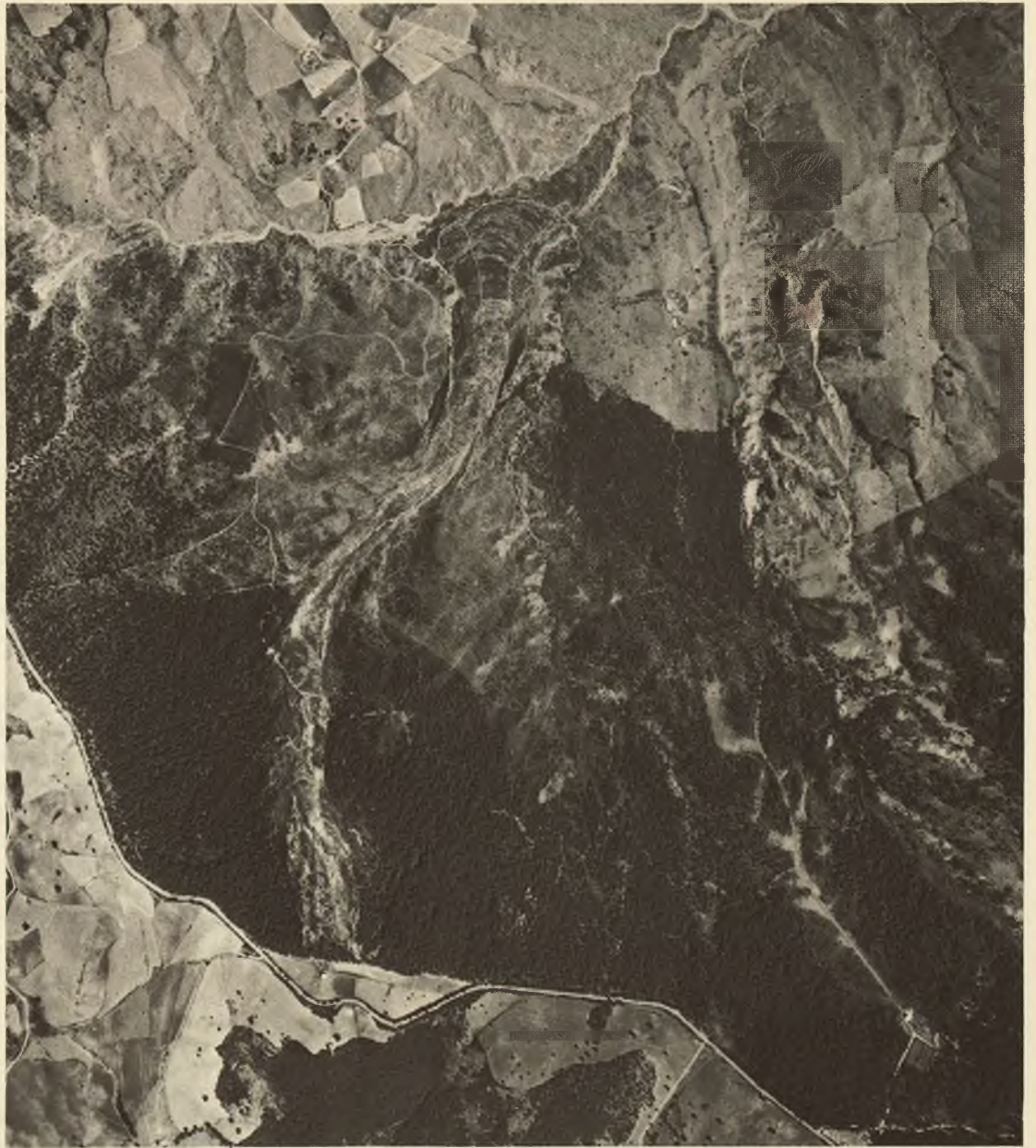
Foto 11 Frana mista impostata in argille scagliose in località Manche di Tolve costituita da uno scorrimento roto-traslattivo a monte con conseguente colamento dei materiali verso il fondovalle (V.ne Marchigliuzzi). Ben visibile il canale di frana, la zona di deposito e, sulla destra del corpo franoso, terreni interessati da lavori di rimboscimento (km 490 della S.S. Appia; bacino del fiume Bradano).
